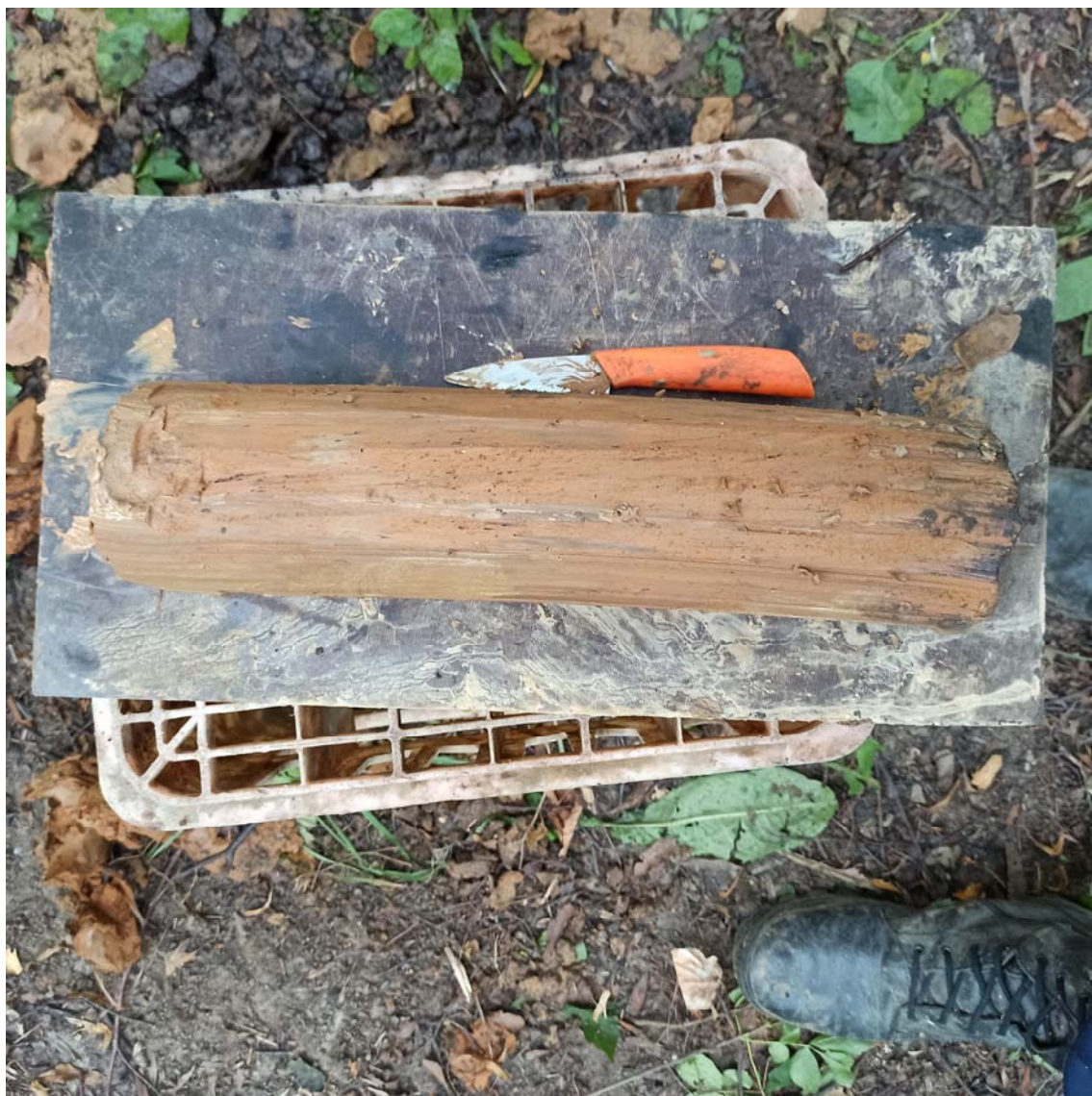
Рисунок 2.3 – монолит из скважины 3
