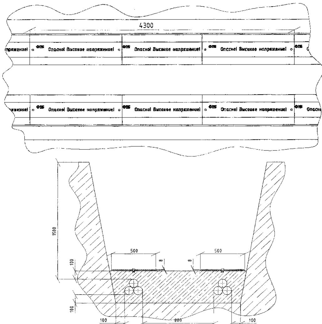
Рисунок А.5 – Типовая схема защиты листами ЛПЗС при прокладке двух параллельных линий
