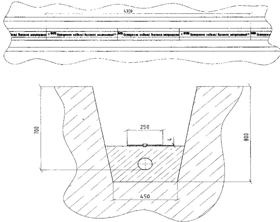
Рисунок А.2 –Типовая схема прокладки кабельной линии напряжением до 35 кВ при размещении одного кабеля (размеры даны в мм)
