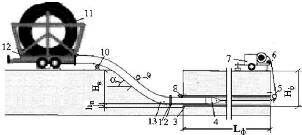
1 – опорное кольцо; 2 – приямок; 3 – футляр; 4 – оголовок; 5, 8, 9, 10 – ролики (для троса, защитный, прижимной и опорный); 6 – трос; 7 – лебедка; 11 – барабан с ТрК;
