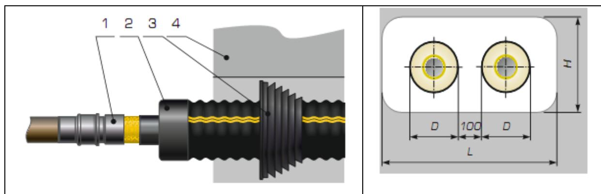
1 – соединительная деталь с приваренным металлическим патрубком, 2 – концевой термоусаживаемый предохранитель, 3 – стеновой уплотнитель, 4 – стена здания
