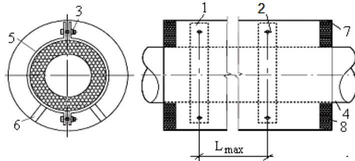
а) полухомут; б) опора\* в сборе; в) расположение ТрК в футляре;
