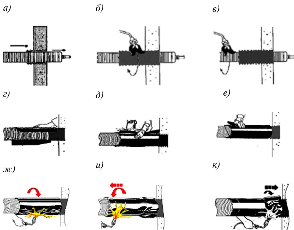
Рисунок 7.2 – Последовательность выполнения прохода ТрК через стену камеры
