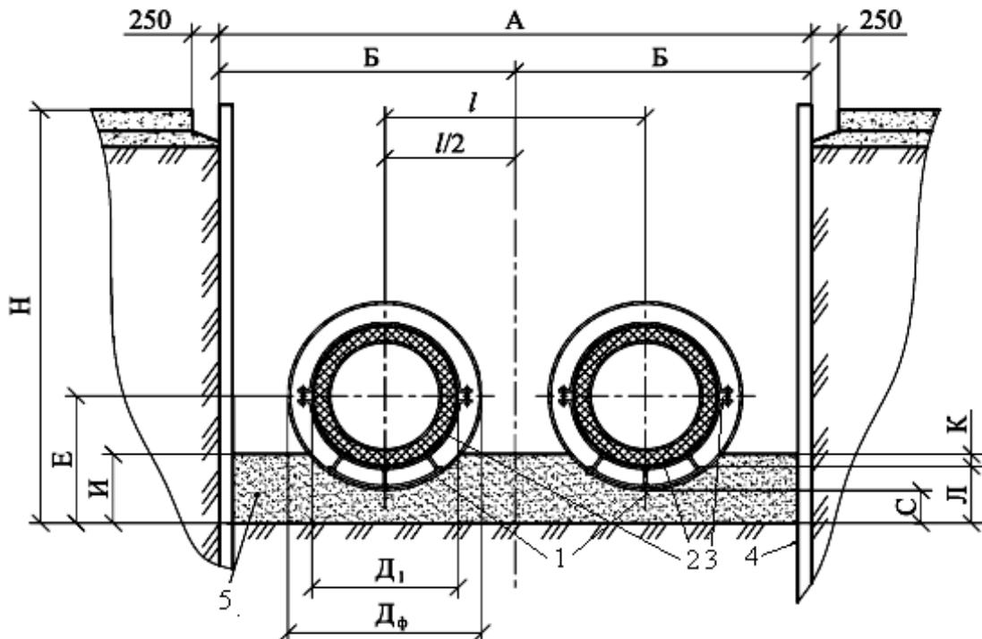
1 – футляры; 2 – ТрК; 3 – хомутовые опоры; 4 – инвентарное крепление стенок траншеи; 5 – основание под футляры
