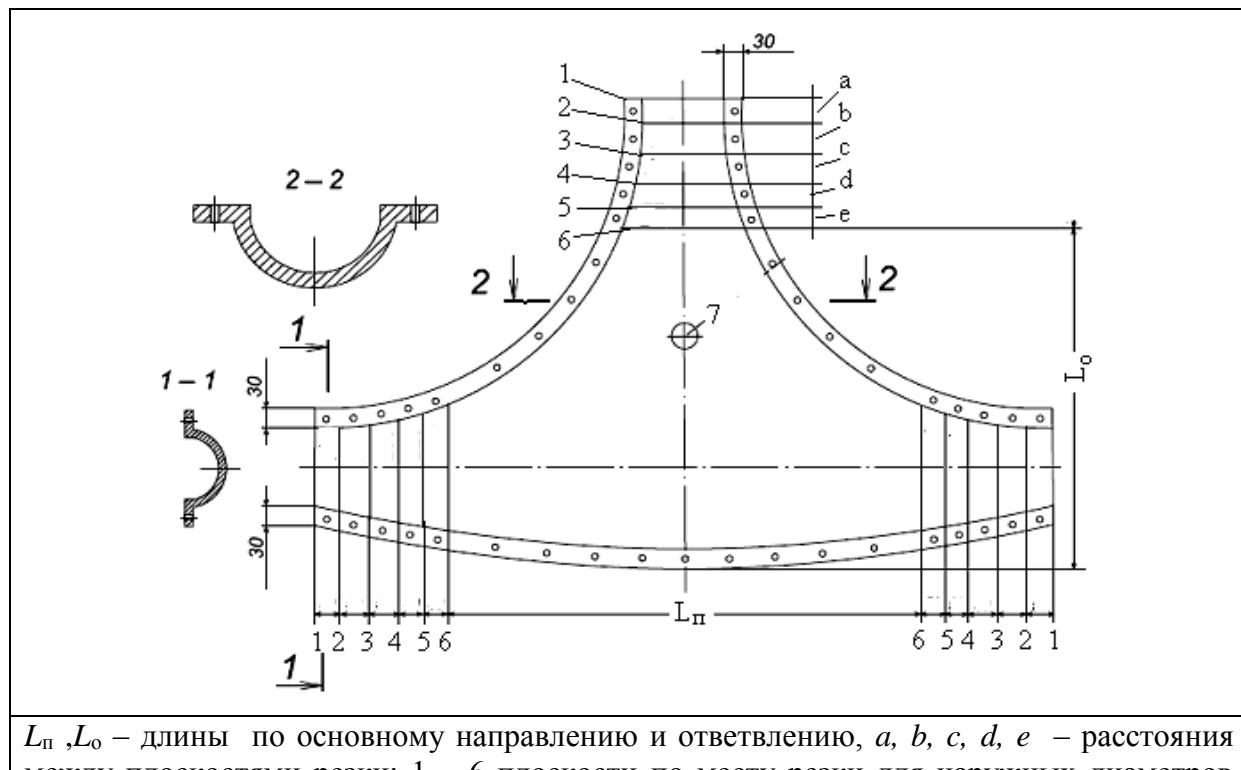
$L_{\pi}$ ,  $L_o$  – длины по основному направлению и ответвлению,  $a$ ,  $b$ ,  $c$ ,  $d$ ,  $e$  – расстояния между плоскостями резки; 1 – 6 плоскости по месту резки для наружных диаметров оболочек, 7 – отверстие для заливки пены
