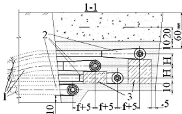
*a)* прокладка ВГТгнт из двухтрубных Тр; *б)* прокладка ВГТгнт из четырехтрубных ТрК;  $D_1$  – максимальный наружный диаметр кожуха;  $D_2$  – наружный диаметр оболочки верхнего трубопровода;  $H$ ,  $f$  – минимальные межосевые расстояния между ТрК по высоте и в плане; 1 – трубопровод; 2 – кожух для изоляции тройника; 3 – подпирающие основания
