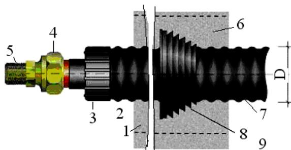
1 – стена; 2 – подвал; 3 – концевой предохранитель; 4 – соединительная деталь;
