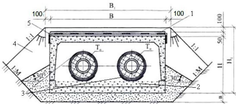
1 – гидроизоляция; 2 – основание под конструкциями; 3- ТрК; 4 – гравийная засыпка; 5 – канал;  $T_n$ ,  $T_o$  – подающий и обратный трубопроводы отопления,  $B$ ,  $H$  – ширина и высота канала;  $T_n$ ,  $B_1$ ,  $H_1$  – ширина и высота обваловки канала гравием;  $b$  – толщина основания под каналом; 1:М – угол естественного откоса
