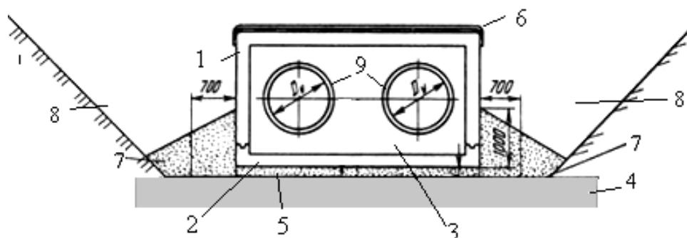
1 – железобетонная рамная секция; 2 – железобетонная плита днища; 3 – песчаная подушка; 4 – песчаное основание; 5 – бетонная подготовка; 6 – гидроизоляция, 7 – гравий (щебень), 8 – траншея; 9 – ТрК
