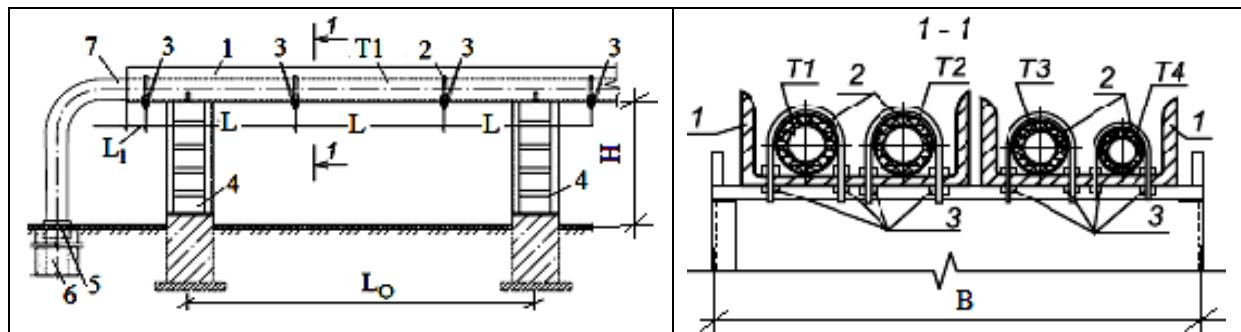
T1, T2 – теплопроводы подающий и обратный, T3, T4 – горячие водопроводы, подающий и циркуляционный, Lo, L - расстояния между опорными стойками и креплениями, L<sub>1</sub> – расстояние от крепления до края опоры (макс. ~ 500 мм), H – расстояние от трубы до поверхности земли, B – ширина площадки для размещения труб; 1 – швеллер (ГОСТ 8240, ГОСТ 8278, ГОСТ 19425); 2 – хомут\*(ГОСТ 24137); 3 – резьбовое соединение; 4 – стойки; 5 – узел сопряжения\*\*; 6 , 7 – подземный и надземный трубопроводы
